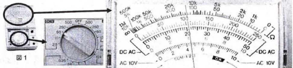
寺林君は車のバッテリーの電圧を測定しました。測定には授業でも使ったテスタ (図 1) を使いました。測定するときにはつまみを図 2 のようにセットし、結果は図 3 となりました。測定結果を単位もあわせて答えなさい。
